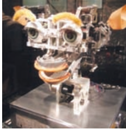
1993 yılında Amerika’daki MIT üniversitesindeki araştırmacıların yarattığı “Kismet” isimli bu robot, insanlarla sevinç, üzüntü ve öfke gibi duygusal tepkiler vererek iletişim içine girebiliyor.
